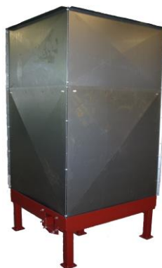
1,0 X 1,0 m. Med väggar som går upp mot inner taket och fylls genom hål i taket.
